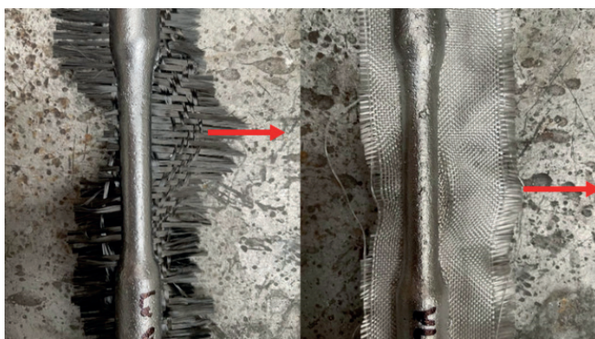
Obr. 8. Možnost vytažení vláken vlivem špatného spojení mezi matricí a vlákny
