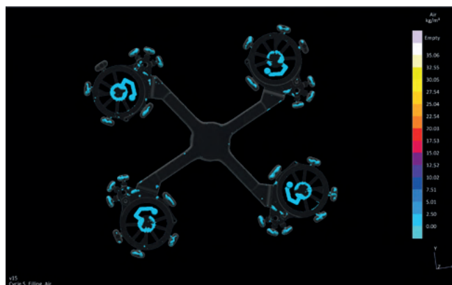
Obr. 14. Výsledek kritéria Filling Air při konečném řešení technologie
