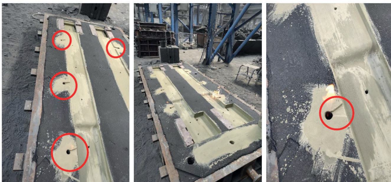
Obr. 5. Příprava vzorků při očkování pomocí SUPERSEEDU
