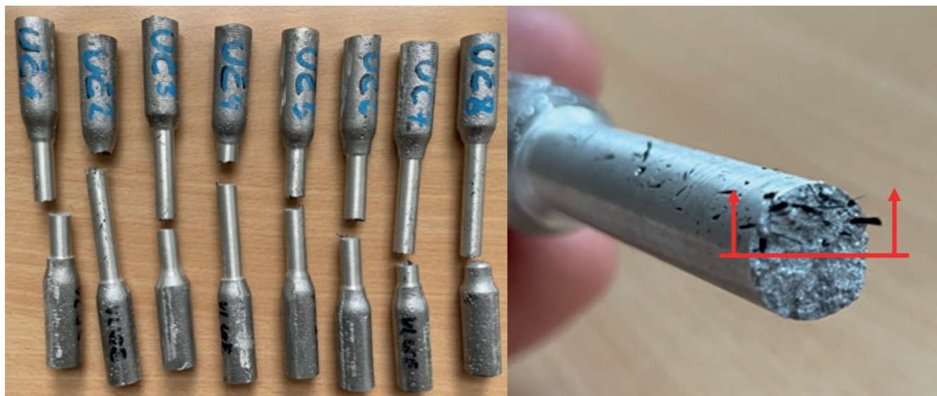
Obr. 10. Vzorky hliníkové slitiny se sekaným uhlíkovým vláknem po tahové zkoušce
