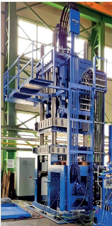
Obr. 1. Koncepce lícího stroje – squeeze casting
